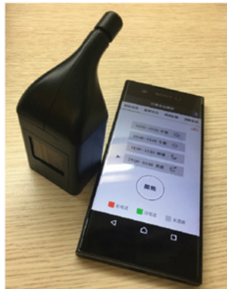
圖1、攜帶型酒測器及裝置在智慧型手機中的應用程式
