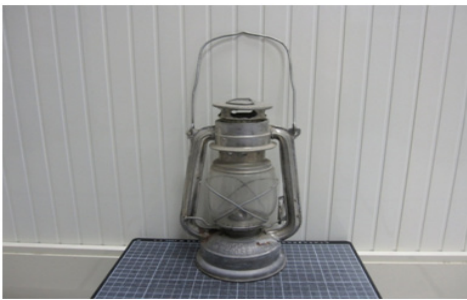
照片 1：馬燈的設計簡單，既方便、耐用又省油，要明亮或是暗淡，只要輕輕轉一下燈芯的長短即可。
